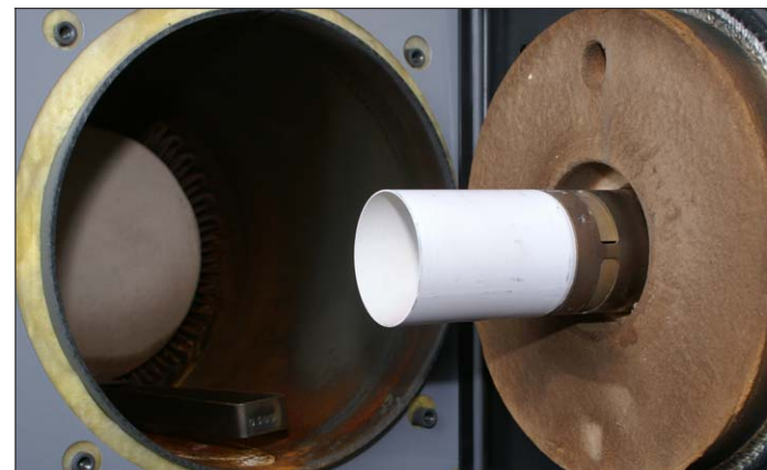
Das mit Nanopartikeln beschichtete Flammenrohr hält Temperaturen bis zu 1500 Grad aus. Fotos Schmid
