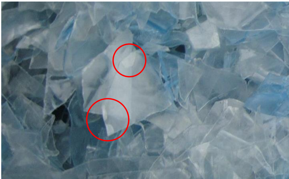
Abbildung 3: PET-Flakes neigen an den Schnittkanten zum Aufblättern
