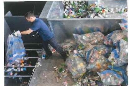
Das Kunststoff-Losematerial aus Säcken und Presscontainern wird auf den PET Plätter aufgegeben. Dieser bearbeitet die PET Flaschen so, dass sie flach sind und im Sortierprozess nicht rollen können.
