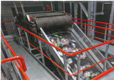
Das vereinzelte und geplättete Kunststoff-Mischmaterial wird durch einen Magneten und einen Nichteisenabscheider von Metallteilen befreit. Die Metalle werden wieder der stofflichen Verwertung zugeführt.
