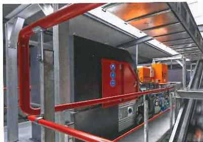
Das Kunststoff-Mischmaterial wird auf sechs elektronischen Sortiermodulen vollautomatisch nach Farbe und Material sortiert.
