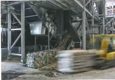
90% der zu sortierenden Kunststoffe wird in gepressten Ballen über den Bahnanschluss an die Anlage angeliefert.
