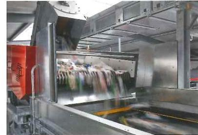
Das gesamte 3D Material wird mit einem rotierenden Scheibensieb nochmals von Kleinteilen befreit. Zugleich werden die Flaschen so vereinzelnd, dass die Plastikflaschen einzeln auf dem Beschleunigungsband des elektronischen Sorters in Monobelegung zu liegen kommen.
