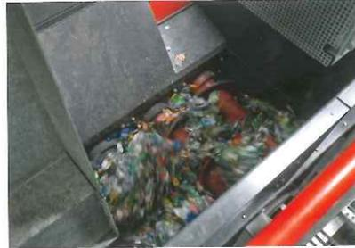
Die gepressten Kunststoffballen werden mittels Hubstapler auf das Beschickungsband gestellt, die Bindedrähte entfernt und in den Trichter des Brechers gefördert. Der Ballenbrecher vereinzelt die Flaschen ohne diese zu zerkleinern.
