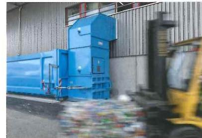
Der verbleibende Restabfall wird in einem stationären Presscontainer verdichtet und der Kehrlichtverbrennung zur thermischen Verwertung zugeführt.
