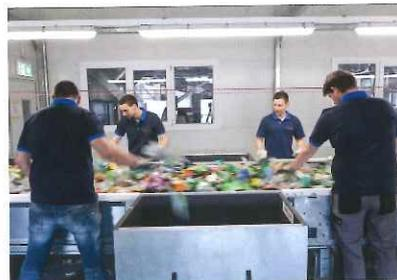
Um bei den Plastikflaschen z.B. «PET Clear» die Reinheit von > 99.96% zu erreichen, werden die elektronisch vorsortierten Kunststoffe von Hand nachsortiert.
