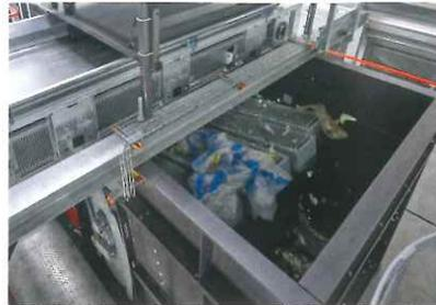
Das von Metallen befreite Kunststoff-Mischmaterial wird auf einem Ballistiksichter in drei Fraktionen aufgeteilt:
