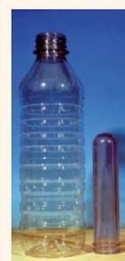
Heute wird der Preform in großen Mengen separat vorproduziert, die PET Flasche wird vor Ort geblasen und meist direkt danach gefüllt und verschlossen.
